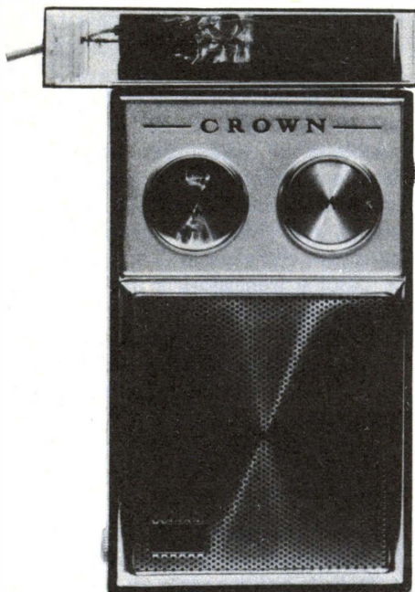
FIG. 5 - L2 va posta vicina e parallela all'antenna in ferrite contenuta nella parte superiore della radiolina.
